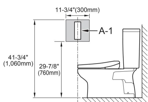
**11** Rear wall / Mur arrière / Pared posterior
