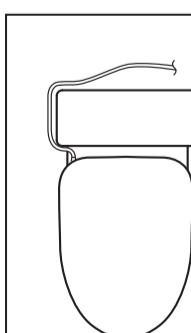
Se a tomada estiver no lado oposto do vaso sanitário desde o cabo de alimentação, passe o cabo de alimentação ao redor do lado traseiro do depósito.
